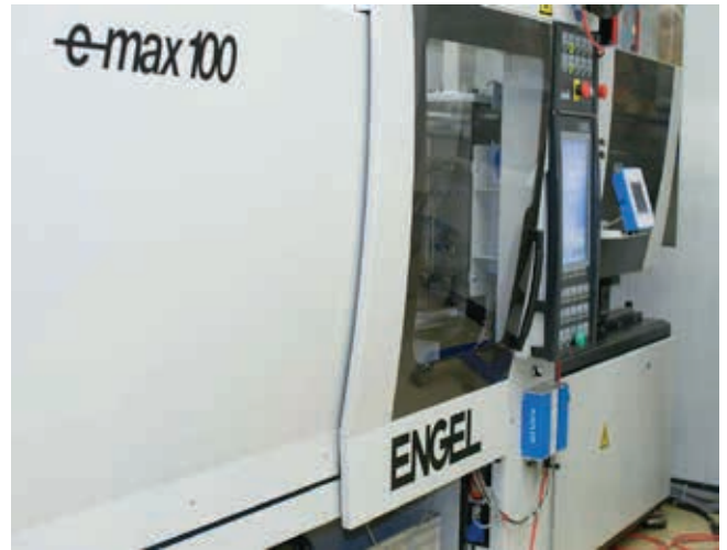
» Kistler CoMo Injection Tip 2869B2 ... (desno pored ubrizgavalice) prati izradu konektora.
