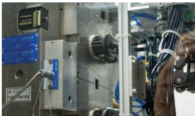
» Višekanalni utikač na vanjskoj strani alata objedinjuje sve signale u jednom kabelu te ih povezuje sa sustavom CoMo Injection
