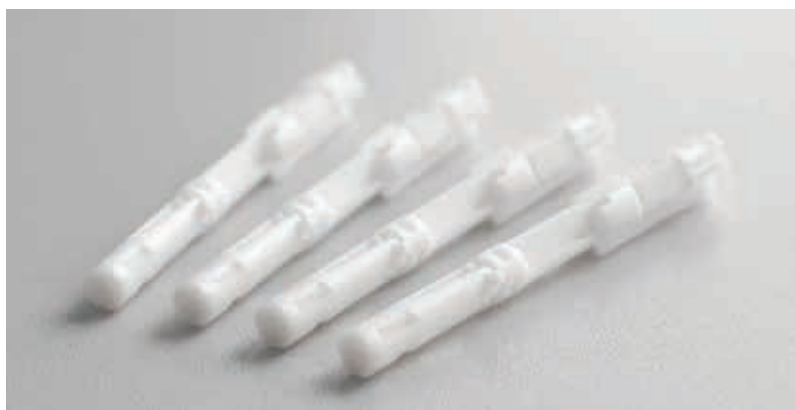
» Zahtjevna držala lanceta, injekcijski prešana u kalupu sa četiri kalupne šupljine, načinjena su od teflonski modificiranog polioksimetilena (POM).
