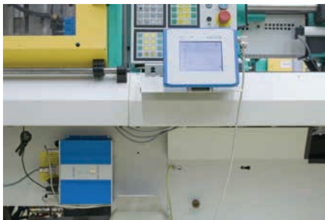
» Sustav za praćenje procesa injekcijskog prešanja CoMo Injection sa zaslonom osjetljivim na dodir (s desna pored upravljačke ploče ubrizgavalice) brine o automatskom izdvajanju loših otpresaka.
