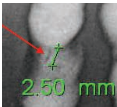
» Slika 8: Digitalna (CR) radiografija - Povećanje greške na uzorku 4.
