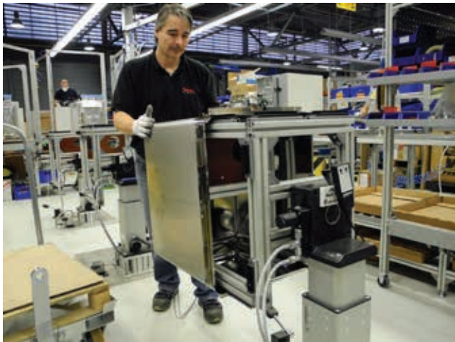
» Kako bi površina spremnika nakon obrade bila što je moguće više neoštećena, bilo je razvijeno stezno pomagalo sa četkicama na naslonj površini. (Slika: ROEMHELD)
