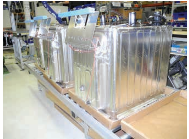
» Nakon montaže termo folije, senzora i držala, unutrašnji spremnik čeka nanošenje izolacije i preko svega montažu unutrašnjeg kućišta. (Slika: ROEMHELD)
