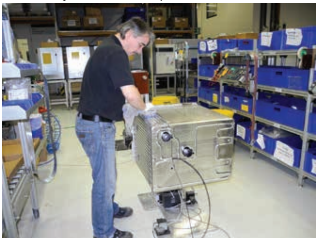
» U predmontaži suradnik sa svih pet strana oblijepi spremnik s termo folijom, a pri tome ga mora više puta okretati. (Slika: ROEMHELD)
