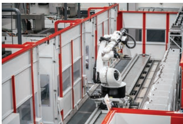
» Robot zagotavlja popolnoma avtomatizirano zaporedje frezanja, čiščenja in merjenja, kar so zadnji procesni koraki končne obdelave orodij za brizganje plastike v podjetju Hermle. Vir: Hermle
