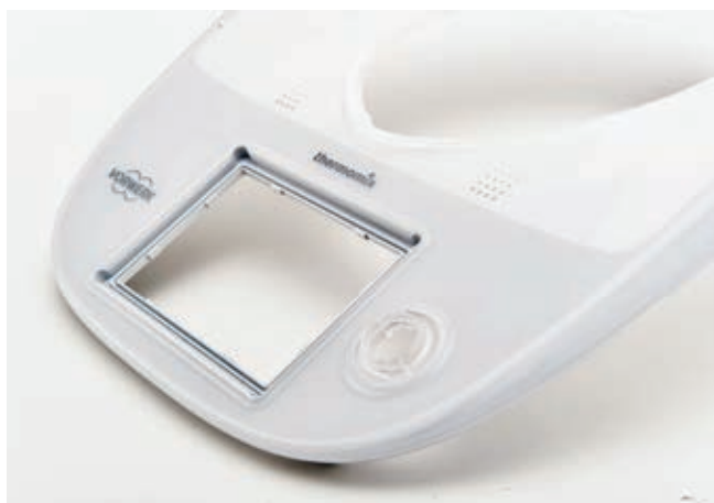
» V podjetju Hofmann so specializirani za večkomponento brizganje plastike, ki omogoča kombinacijo plastičnih materialov različnih barv. Vir: Hermle
