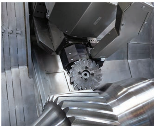
» Podjetje WFL je predstavilo frezalo InvoMilling za obdelavo zobnikov velikega premera. Vir: WFL
