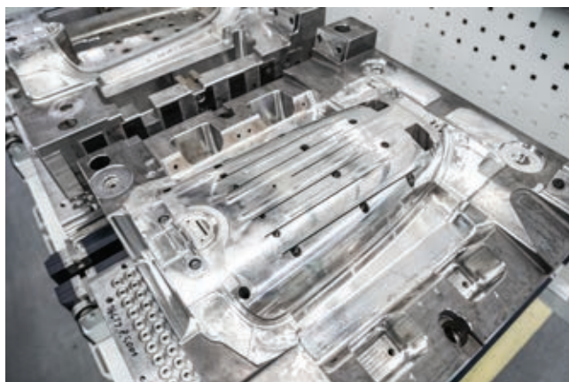
» Končna obdelava orodij za brizganje plastike lahko traja do 50 ur. Vir: Hermle
