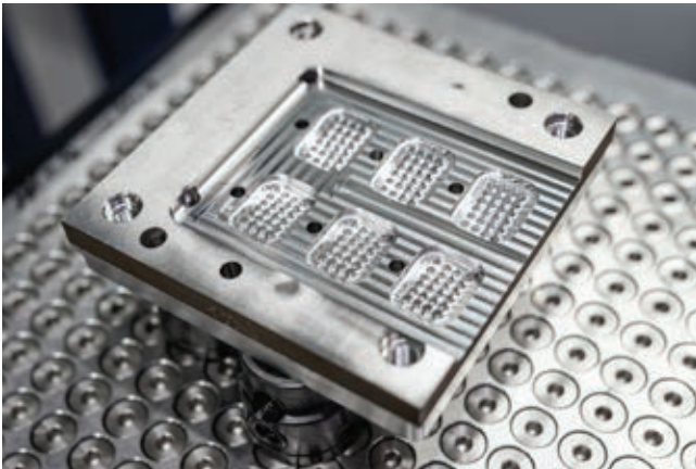
» Po končni obdelavi so komponente orodij za brizganje plastike očiščene, pomerjene ter pripravljene na vgradnjo v orodje. Vir: Hermle
