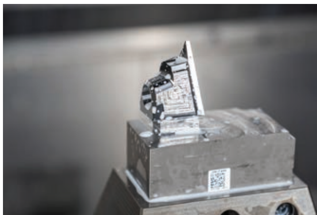
» Markus Gräf je prepričan, da zelo malo obdelovalnih strojev na trgu lahko obdelata 3D-konture na obdelovancih iz kaljenega jekla s takšno natančnostjo kot obdelovalni stroji podjetja Hermle. Vir: Hermle
