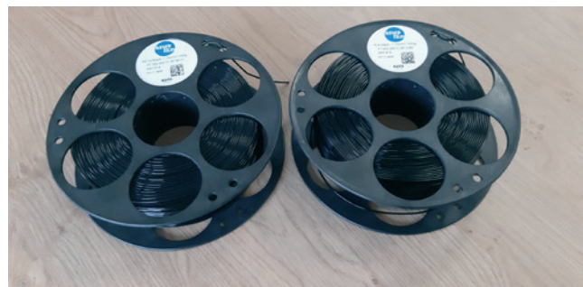
» Slika 10: Koluta iz biokopomozita rPP/odpadni papir/PP-g-MA za filament za 3D tisk
