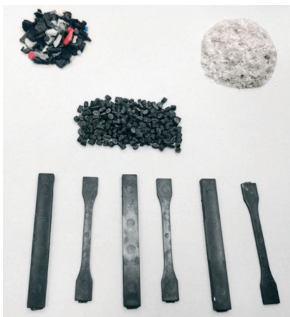
» Slika 1: Reciklat polipropilena, odpadni papir, granulati biokompozita z 10 % odpadnega papirja in brizgani vzorci za testiranje
