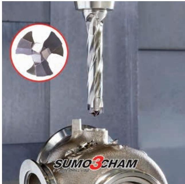
Jedinstvena geometrija SUMO3CHAM sa samocentrirajućim oblikom glavice za bušenje proizvodi optimalni oblik odvojene čestice, kako bi omogućila njihovo odvođenje kroz 3 visoko zavijena polirana utora.
