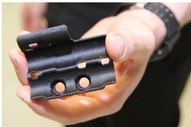
» Nosilec hidravlične napeljave za McLarnov dirkalnik MCL32, ki je bil natisnjen na 3D-tiskalnik Stratasys FDM iz materiala Nylon 12CF.
