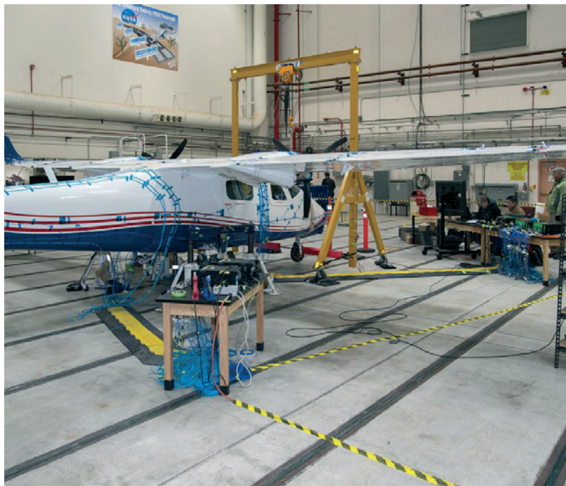
» Testi vibracij so se izkazali kot pomemben mejnik pri razvoju novega letala X-57 "Maxwell". | Vir: Hottinger Brüel & Kjær
