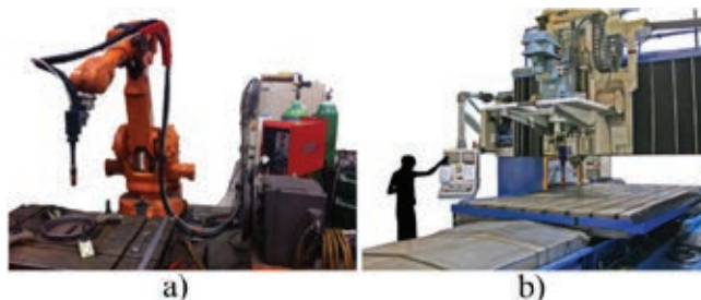
» Slika 1: a) 6-osna robotska in b) 3-osna CNC konfiguracija sistema za navarjanje.
