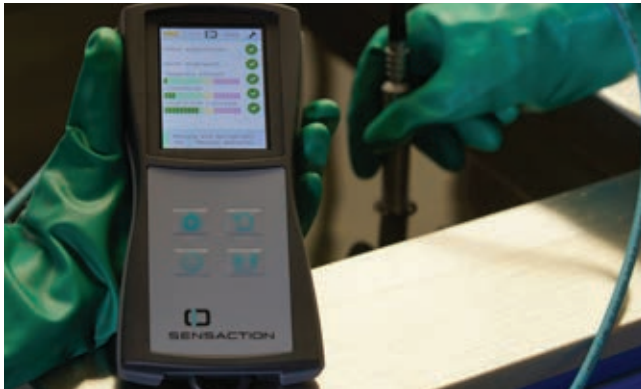
» Prijenosni uređaj za praćenje procesa čišćenja LiquidSens Mobile. | Izvor: Endres Medizintechnik
