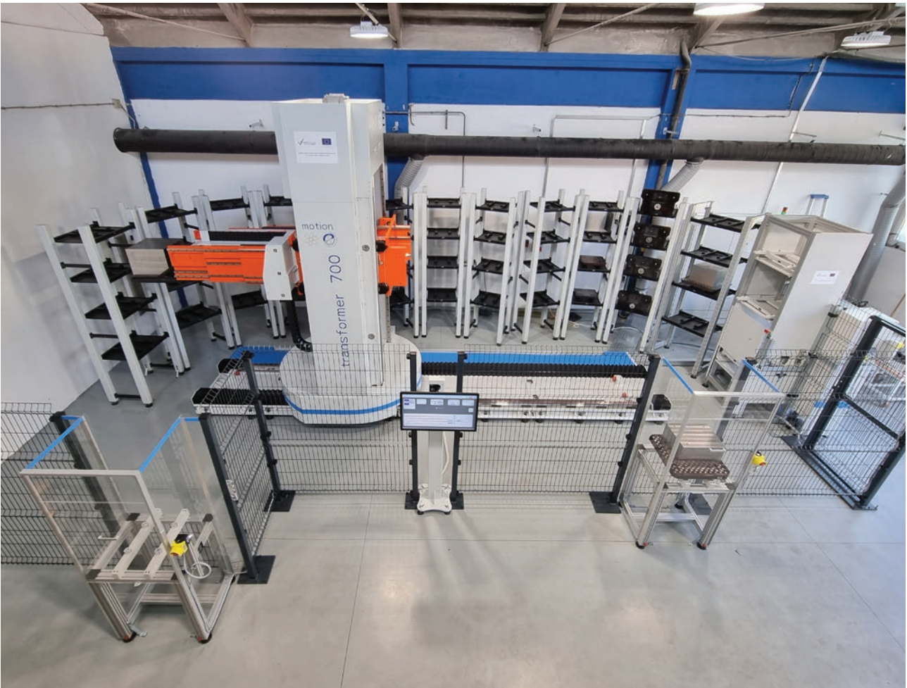
» Prikaz postavljenog hibridnog uređaja, regalnog skladišta paleta, automatske stanice za punjenje
