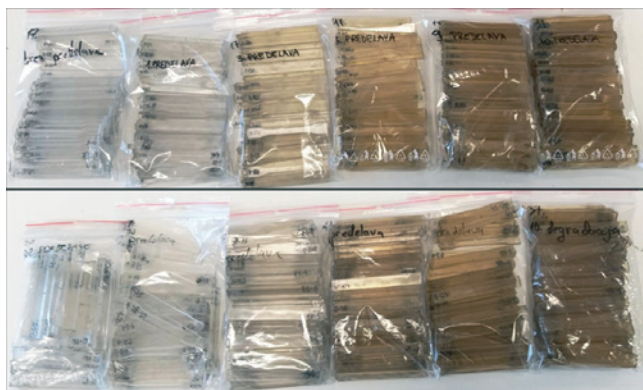
» Slika 2: Nabrizgane epruvete za karakterizacijo linearnega PC (zgoraj) in razvejanega PC (spodaj)
