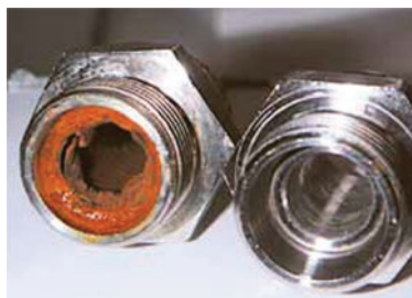
» Povišena produktivnost ostvarena čišćenjem i zaštitom kanala za temperiranje u kalupu
