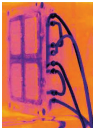
» Slika 1b: Homogena razdioba temperatura u kalupu za injekcijsko prešanje nakon što su kanali za temperiranje očišćeni
