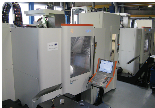
» 5-osni obradni centar Mill P 800 U D u pogonu tvrtke TEH-CUT
