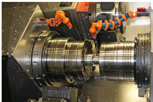
» Preuzimanje komada sa vretenom. Oba vretena imaju sinkronizirani broj okretaja i položaje.
