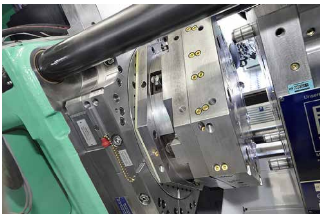
» Slika 1: Vrtljiva miza na stroju z večstopenjskim orodjem
