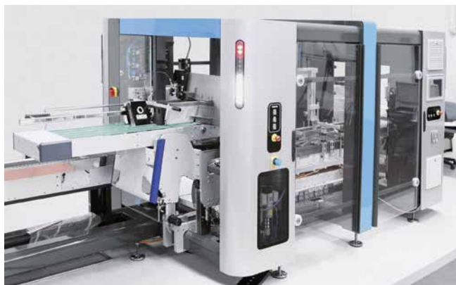
» Izvrstan primjer stroja za pakiranje iz »probitačne generacije«, tvrtke Cama, sa smanjenom tlocrtnom površinom. U tri koraka stroj otvara kartone, napuni ih različitim proizvodima te ih zatvori. (Foto: Festo AG & Co. KG)
