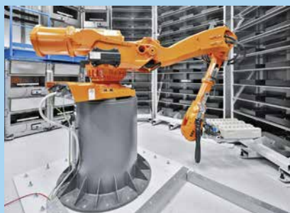
» Potpuno automatizirani uređaj za oblikovanje baterija tvrtke Thyssen Krupp System Engineering, gdje baterije oživljavaju (Foto: ZSW/Duckek)
