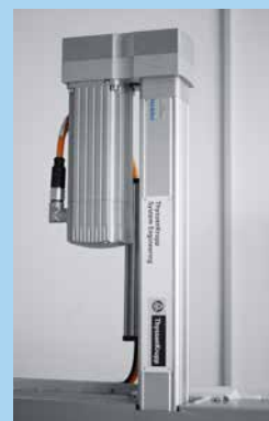
» Električni radni klip DNCE podiže sustav za dodavanje baterija, odakle ih robot uzima te odlaže u uređaj za punjenje i ispitivanje. (Foto: Festo AG & Co. KG)
