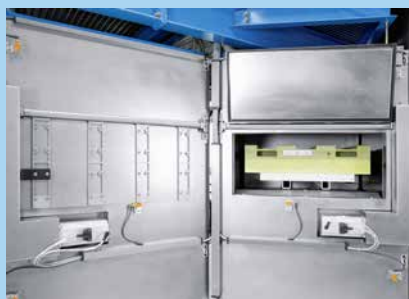
» Koračni motori EMMS-ST otvaraju i zatvaraju uređaj za prvo punjenje i ispitivanje baterija. (Foto: Festo AG & Co. KG)
