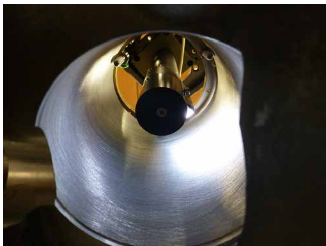
» Merilna glava CylinderInspector med pregledom notranjosti cilindra, ki površino osvetljuje in jo meri brezkontaktno. To daje uporabnikom 360° panoramski pogled, ki se začne na točki po lastni izbiri. Sistem se centrirata neodvisno v območju premerov valjev 60-130 mm. Vir: Opto GmbH
