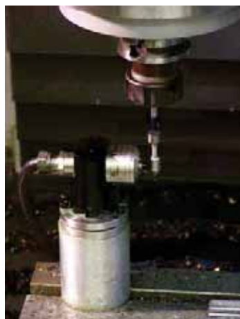
» Merilna glava, nameščena na vreteno, je pomembna za ponastavitev obdelovanca po repositioniranju delov.
