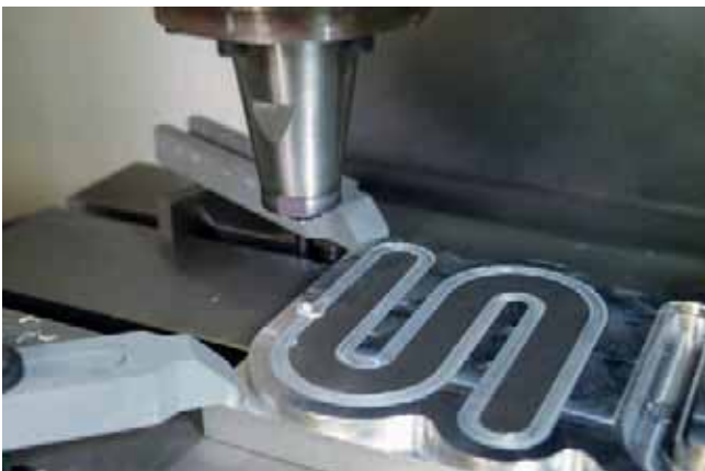
» Varjenje z gnetenjem je robusten postopek spajanja, ki uporablja toploto trenja in silo za izdelavo močnih in robustnih zvarnih spojev različnih kovin ali zlitin z nizkim tališčem.
