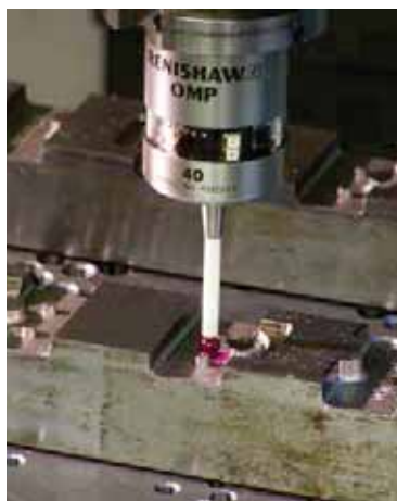
» Nastavljanje orodij na stroju je hitro in upošteva termične učinke.
