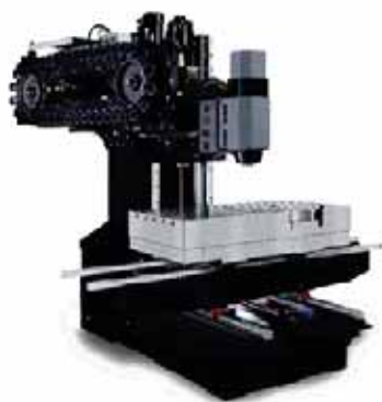
» Toga konstrukcija obdelovalnega centra Hurco VMX42SRTi
