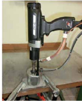
» Slika 7: Oprema za a) kondenzatorsko varjenje čepov [3] in b) za SRM-varjenje čepov [2]
