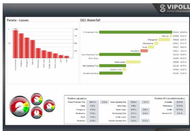
» Model vodopad-dijagrama. Dijagram prikazuje performanse stroja ili linije primjenom dinamičkih varijabli u zenon-u.
