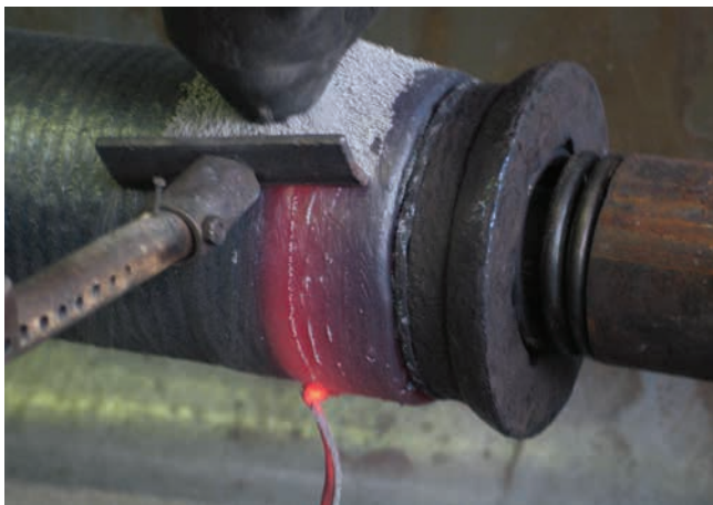
» Odstopanje žlindre s praškom AB123 specialno polnjeno žico za navarjanje
